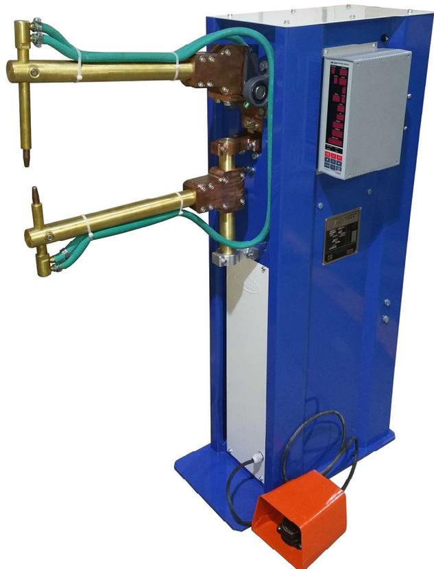
PUNTEADORA BASCULANTE NEUMÁTICA
